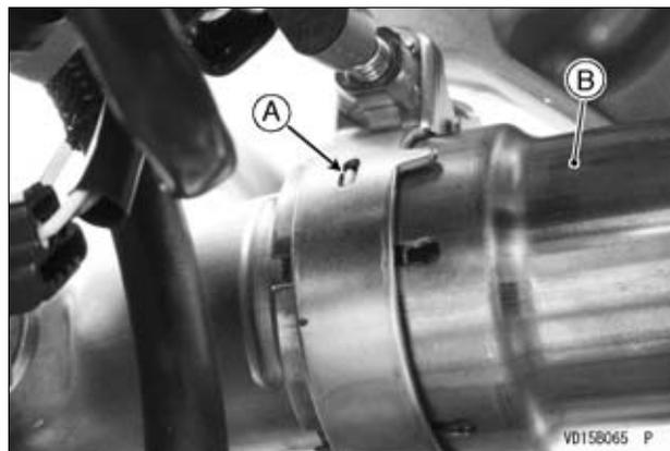
**A. Orificio de la abrazadera del silenciador**
